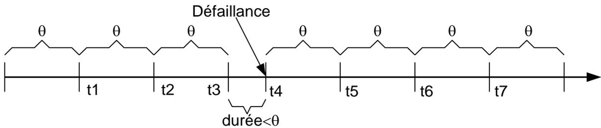
Gestion collective en maintenance préventive systématique : en cas de défaillance résiduelle, le remplacement du composant défaillant ne modifie pas l'échéancier prévu.
