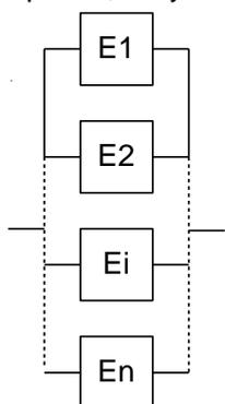
Pour calculer la fonction fiabilité d'un système // à n éléments, il est plus aisé de passer par la fonction défaillance F.
