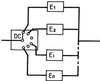
Dans ce cas, un seul élément fonctionne, les autres sont en attente. Ceci a l'avantage de diminuer ou de supprimer le vieillissement des éléments ne travaillant pas. En contrepartie, on a l'inconvénient d'être obligé d'avoir un organe de détection des pannes et de commutation d'un système sur un autre.
